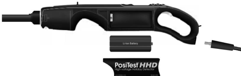
La batería también incorpora un indicador de estado de carga. Pulse el botón de la batería para mostrar la energía disponible. El cargador cambiara automáticamente entre 110 VCA y 240 VCA, lo que la hace ideal para uso en todo el mundo.
